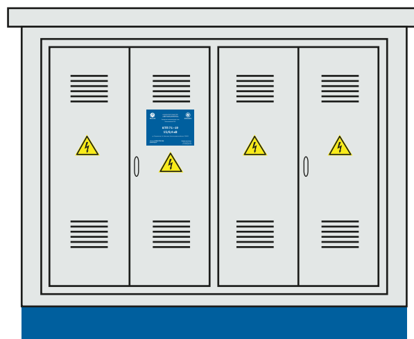
вид спереди КТП 6–15/0,4 кВ с бетонной кровлей
