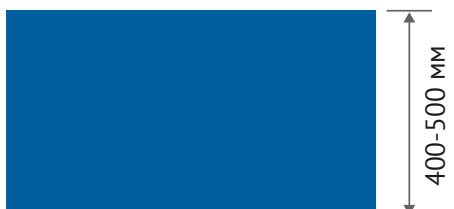
высота окраски цоколя
