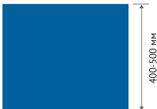
высота окраски цоколя
